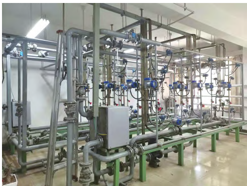
图2 集中供热实验管网示意图
