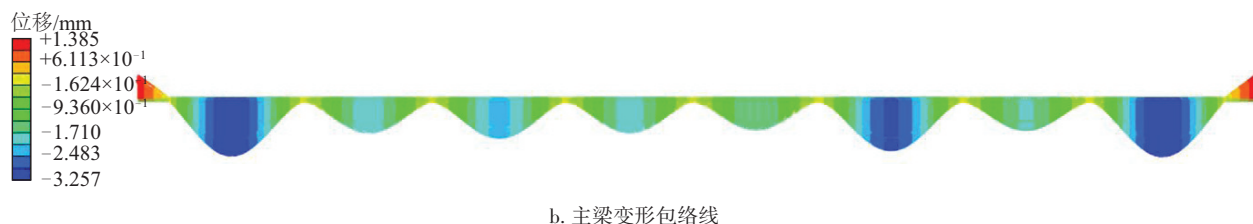
图4 风荷载下45°仰角光伏组件的变形特征
