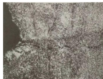
图3 焊缝横向裂纹金相100X(裂纹沿着近熔线焊缝一侧向外表面延伸, 严重处已贯穿)
