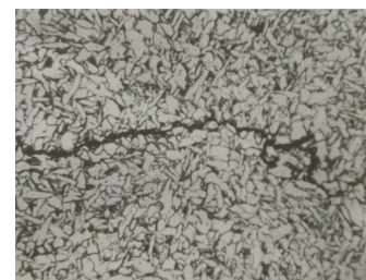
图4 焊缝横向裂纹金相400X(裂纹曲折向焊缝外面发展, 呈沿晶开裂, 裂纹中充满氧化物, 金相组织为珠光体+铁素体, 柱状晶与等轴晶相间排列, 等轴晶晶粒细小, 在8级以上)
