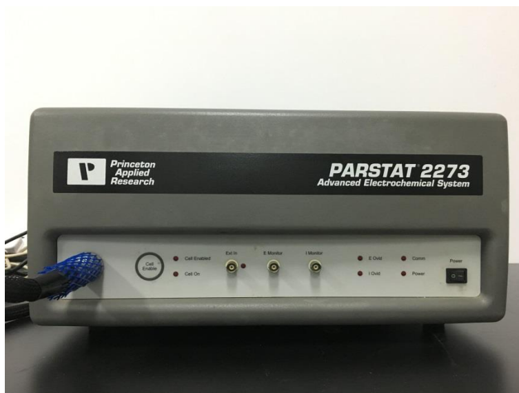
图 2-5 电化学工作站 PARATAT2273
