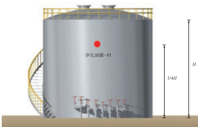
图 C.2-1 带图标标识的拱顶储罐（内浮顶储罐）
